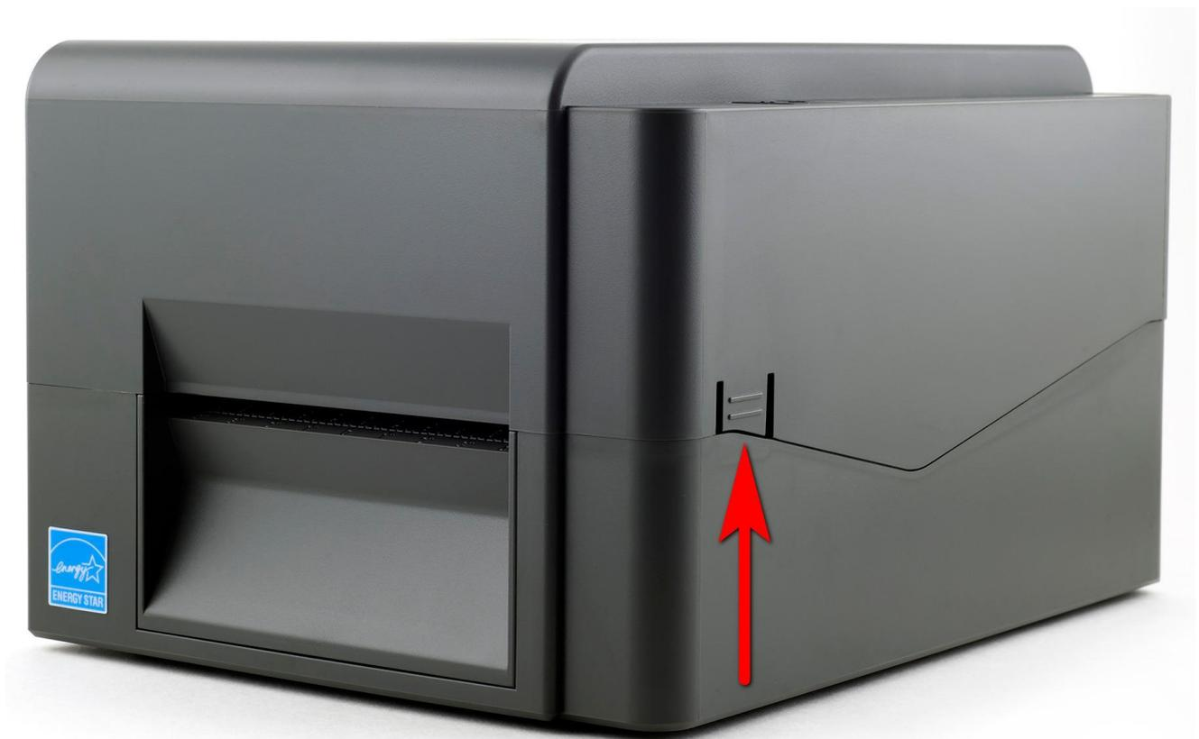
Нажав на зеленую клавишу [PUSH], поднимите блок печатающего механизма.
